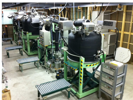
写真1. 減圧式マイクロ波水蒸気蒸留装置(実用機)
